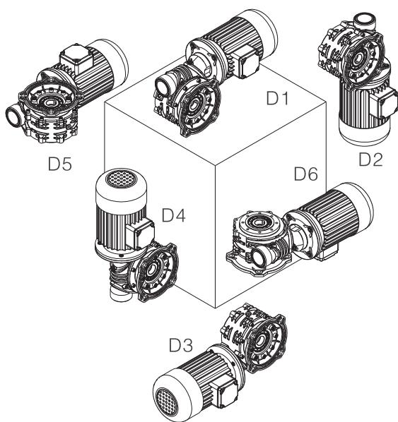
Positions of Motor Terminal Box 电机接线盒位置：
