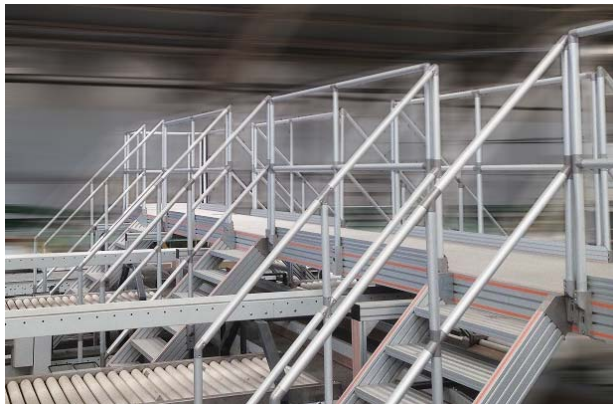
Bridge for Sorting Machine 分拣设备过线梯
